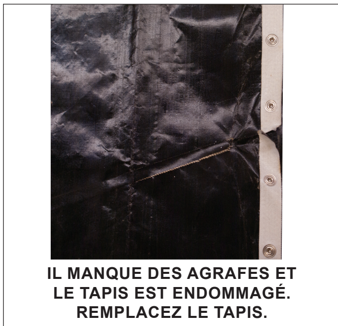
Figure 5. Exemple de tapis endommagé
