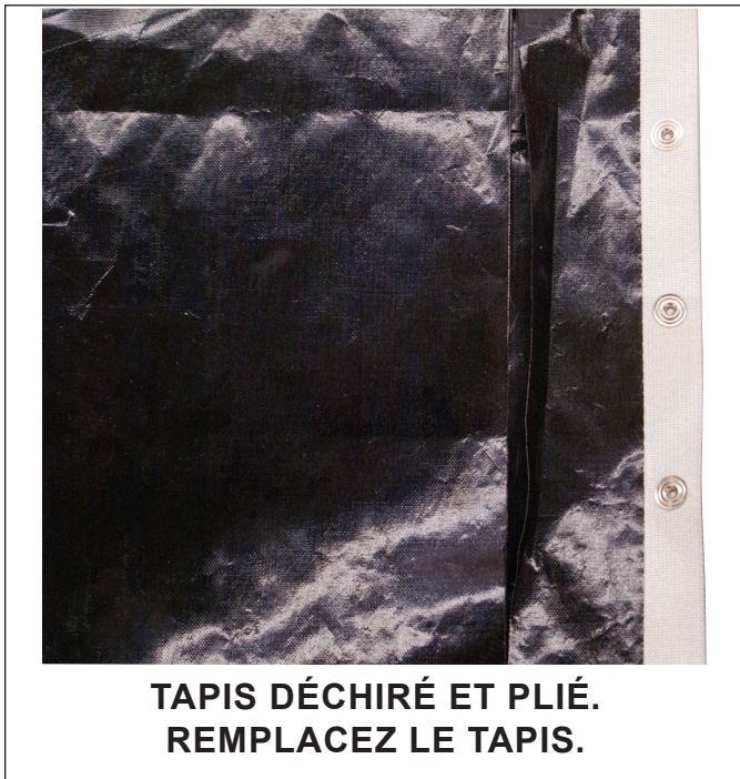
Figure 4. Exemple de tapis endommagé
