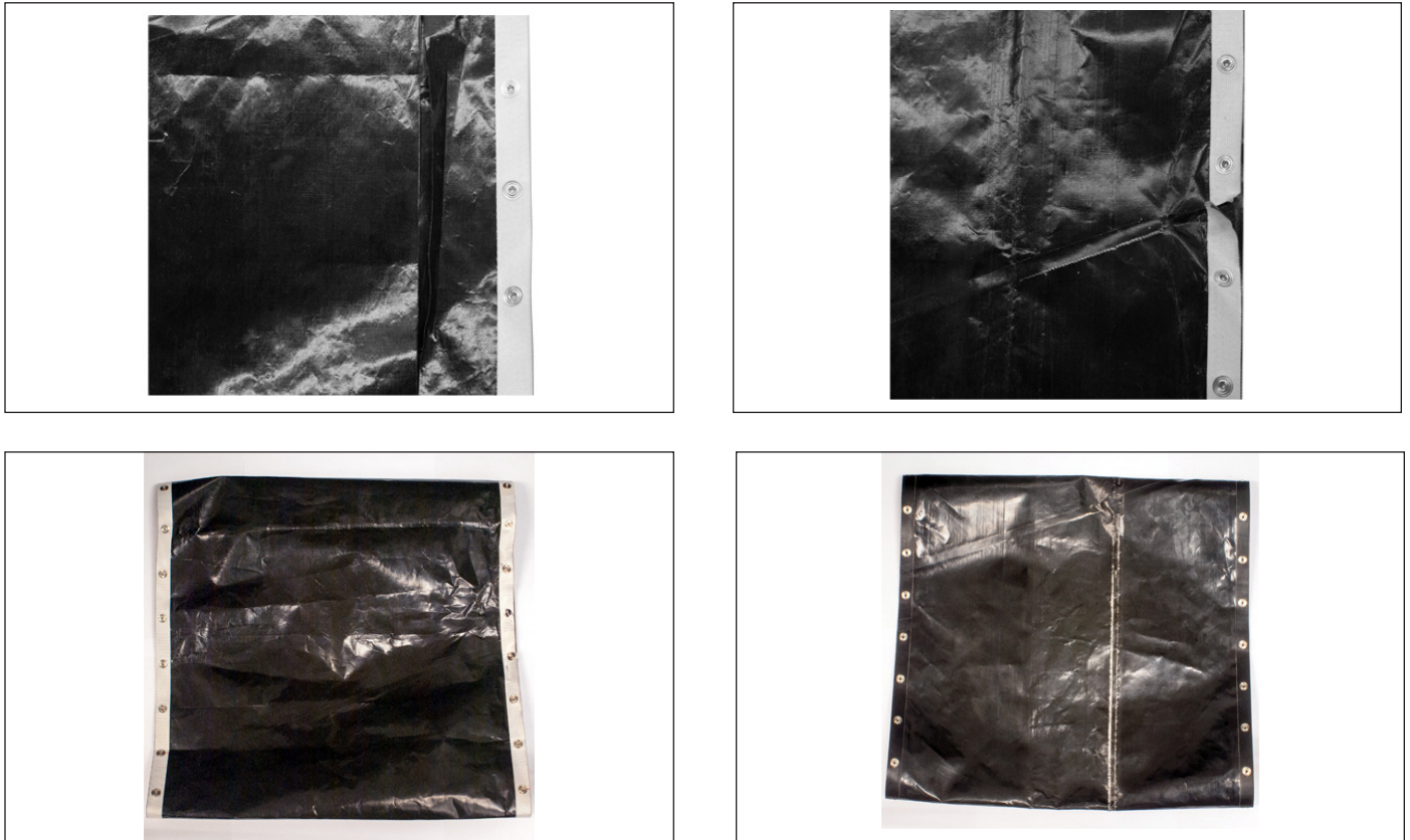
Figure 3. Exemples de tapis endommagés
